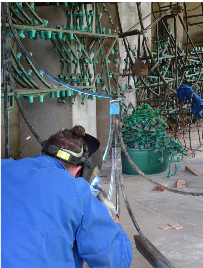
Ré-emploi d'anciennes décorations de Noël de la ville de Thiers par l'artisan-métal de Lao, pour obtenir le baraudage du nouveau portail.
